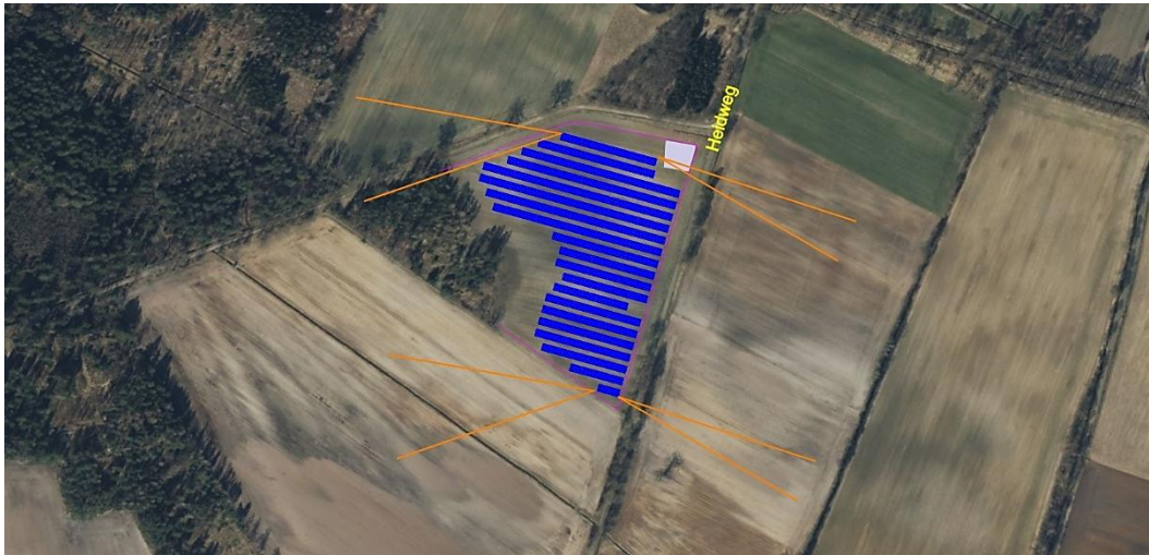
Abbildung 19: Bodennahe Reflexionsrichtungen (orangene Winkel) der PV-Module der Teilfläche B für ausgewählte Eckpunkte der Anlage
