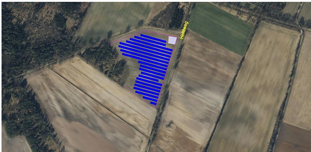
Abbildung 16: Belegung der Teilfläche B (PV-Tischreihen in Blau, Batteriespeicher auf der grau markierten Fläche)
